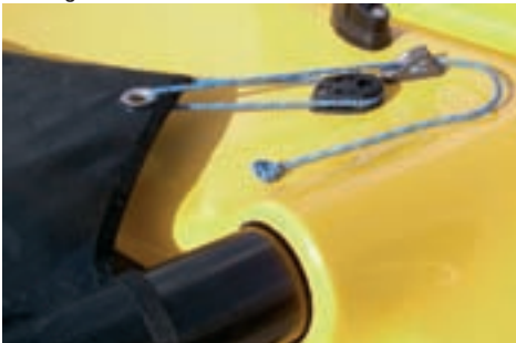
Tendre le trampoline : rien de plus simple avec le système mis au point par le chantier Neo Zed.
